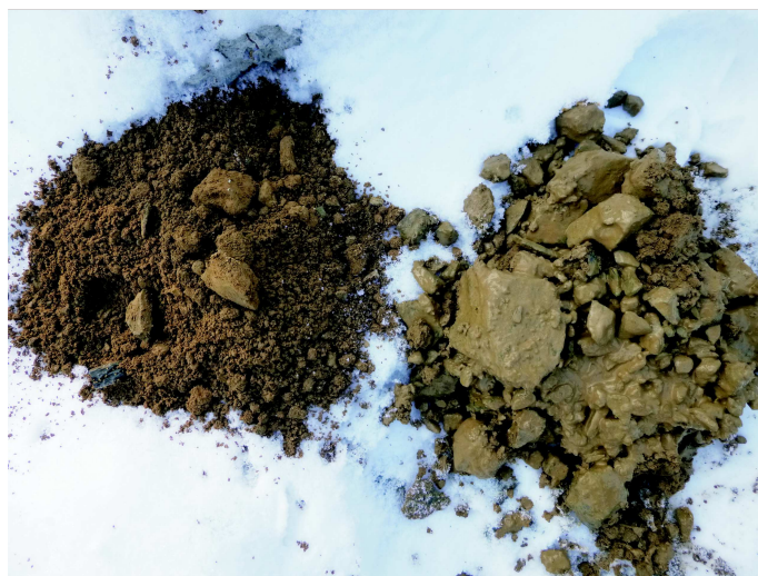
Obr.č.1 - pokryv do hloubky 2,5m návrť do zvětralinového skalního podloží
